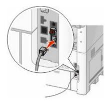
**3** Conecte a outra extremidade ao slot N de uma tomada de telefone ativa.
