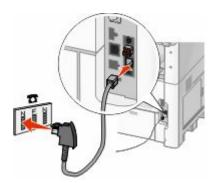
**4** Se desejar usar a mesma linha para a comunicação por fax e telefone, conecte uma segunda linha de telefone (não fornecida) entre o telefone e o slot F de uma tomada de telefone ativa.
